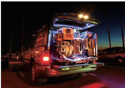
山田さんのバイオディーゼルカー。廃油をバイオディーゼル燃料に精製するためのオリジナル装置を搭載している。
